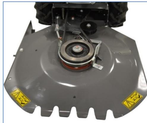
Carter de coupe en acier équipé d'une lame broyeuse type "mulching".
