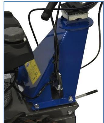
Système de **freinage de la lame** commandé par un levier au guidon assurant un maximum de sécurité.
