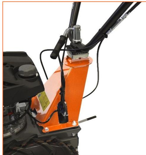
Système de **freinage de la lame** commandé par un levier au guidon assurant un maximum de sécurité.
