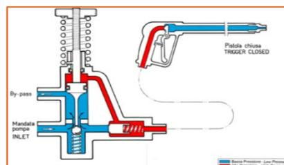
**Dispositif "Easy start"** qui permet un démarrage constant du nettoyeur y compris en présence de chute de tension.
