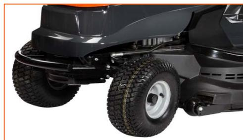
L'opérateur enclenche la lame simplement en actionnant le **bouton de commande de l'embrayage électromagnétique**. Ce système élimine le patinage de la courroie et permet d'enclencher la lame avec précision et sans à-coups.
