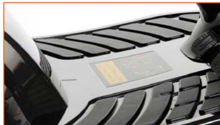
**Le raccord rapide deck wash system** permet de diriger l'eau directement à l'intérieur du plateau de coupe pour faciliter les opérations de nettoyage.
