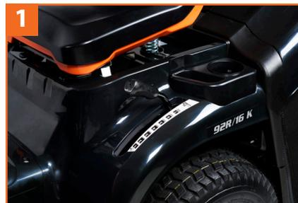
**L'opérateur enclenche la lame simplement en appuyant sur le bouton de commande** de l'embrayage électromagnétique. Ce système élimine le patinage de la courroie de transmission et permet d'enclencher la lame avec précision et sans à-coups. **(2)**
